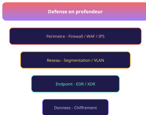
Modele de defense en profondeur - 4 couches de securite
