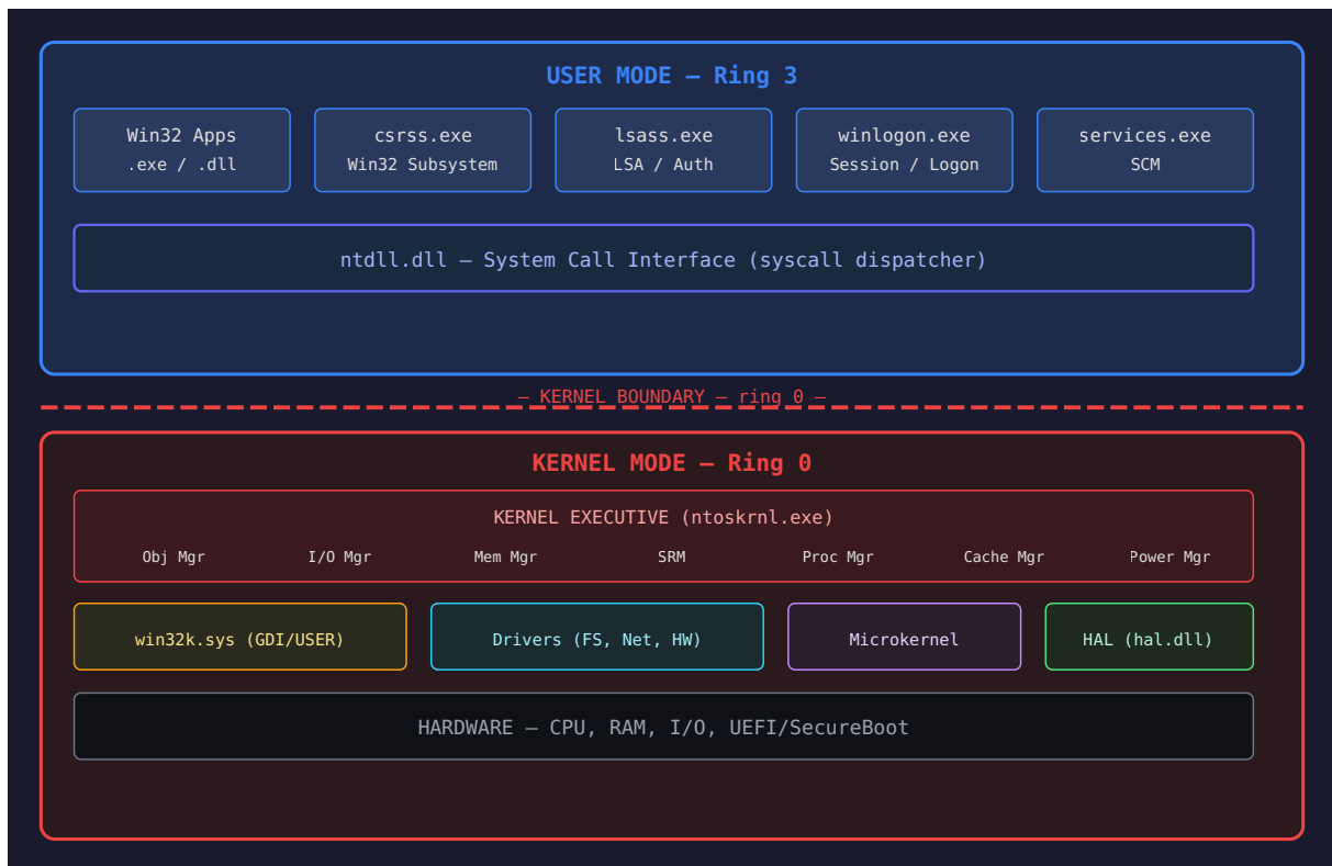
Schéma de l'architecture NT — séparation User Mode / Kernel Mode avec les composants principaux
