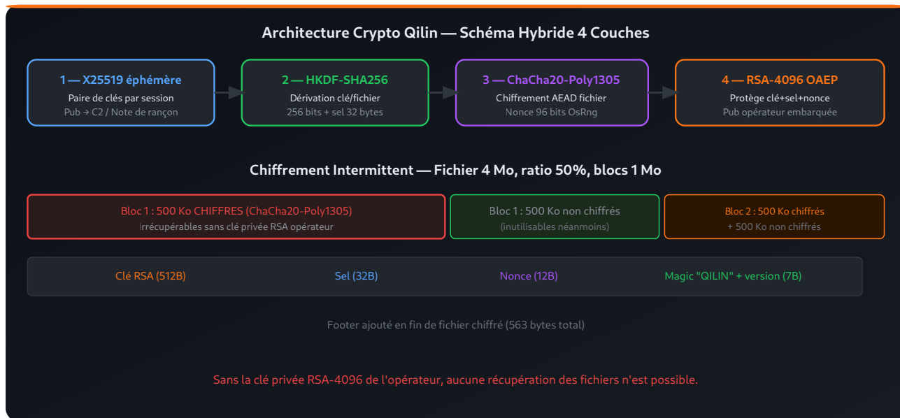
Fig. 2 — Architecture cryptographique Qilin : 4 couches de protection et structure d'un fichier chiffré avec footer.
