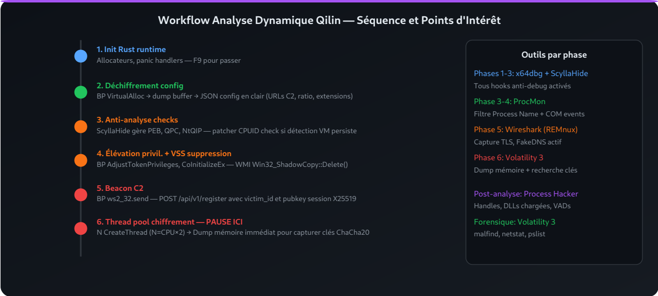
Fig. 3 — Séquence d'exécution supervisée de Qilin dans x64dbg : 6 phases clés avec outils associés et points de capture.
