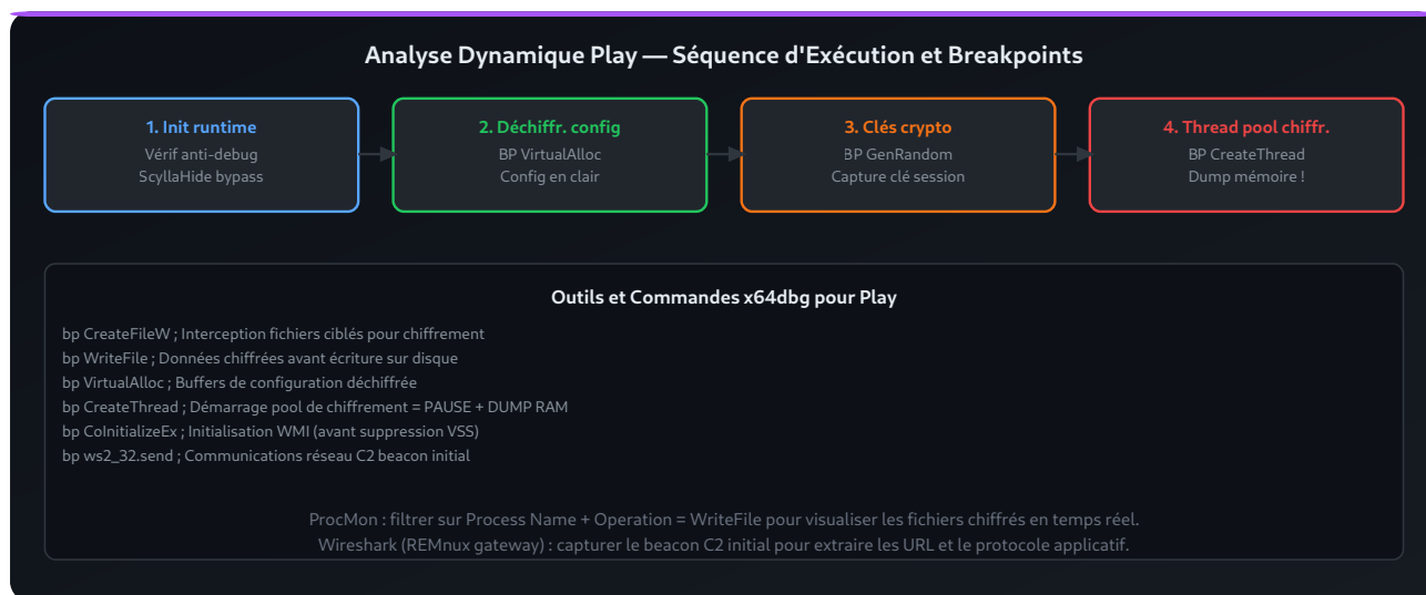
Fig. 2 — Séquence d'analyse dynamique de Play dans x64dbg : 4 phases avec breakpoints stratégiques et actions de capture.
