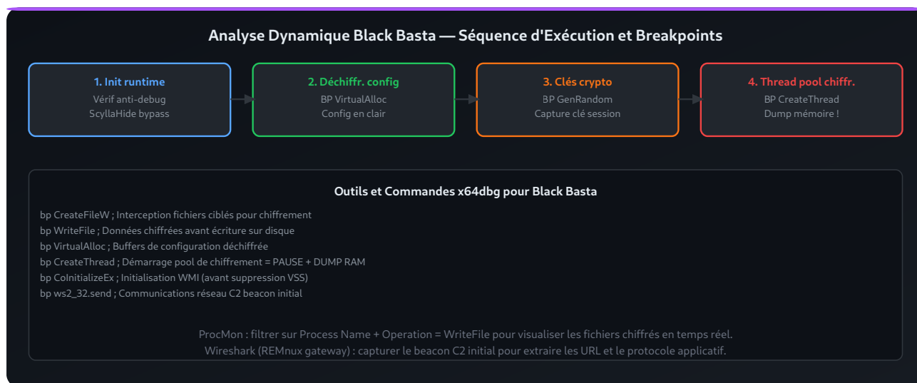
Fig. 2 — Séquence d'analyse dynamique de Black Basta dans x64dbg : 4 phases avec breakpoints stratégiques et actions de capture.
